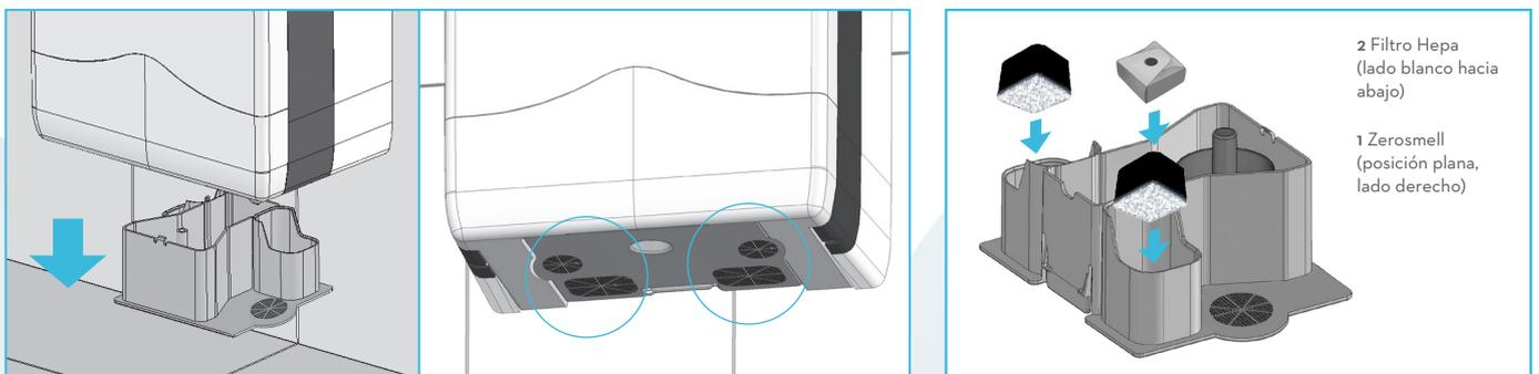
El mantenimiento básico consiste en el vaciado del depósito de agua y limpieza de los filtros de aire siguiendo las instrucciones del manual del usuario. Veltia Hand Dryer cuenta con un depósito electrónico que advierte al usuario la necesidad de mantenimiento por medio de señales luminosas y sonoras.
