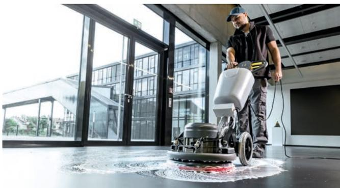
Um Bodenbeläge ohne Chemie zu sanieren, können oszillierende Einscheibenmaschinen zum Einsatz kommen. Foto: Kärcher
